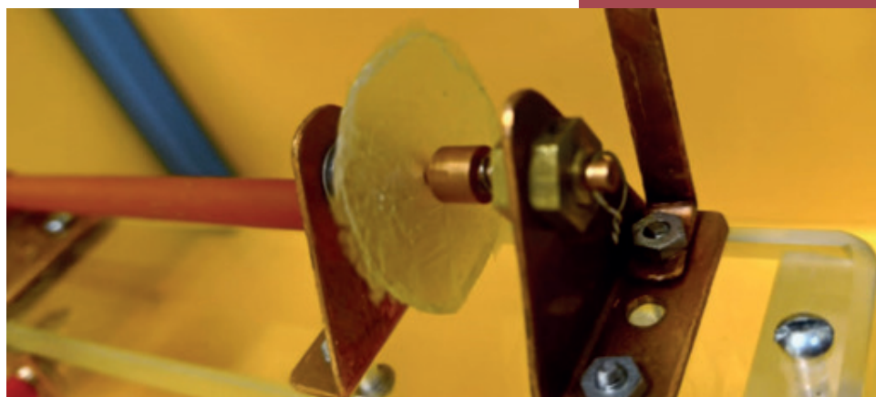
Figura 3. Película de complejo quitina glucano montada entre dos electrodos de cobre para medir su resistencia eléctrica en función del voltaje aplicado.
